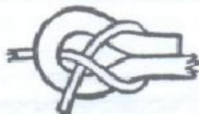
NÓ DE ESCOTA – para emendar cabos de diâmetro igual ou desigual.
