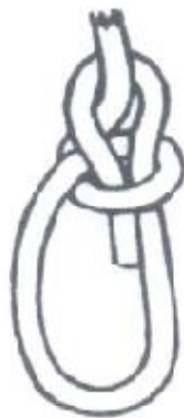
LAIS DE GUIA – formar uma laçada que não corre. É usado para salvamento.
