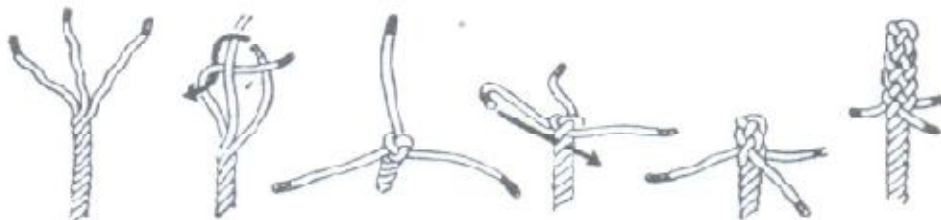
FALÇAÇA INGLESA – para evitar que os cabos de desacochem. Destorça o cabo e entrelace os cordões numa coroa. Passe depois cada cordão por cima do cordão contíguo e por baixo do cordão seguinte, sempre em direção contrária àquela em que o cabo está acochado. Repita isto três vezes.
