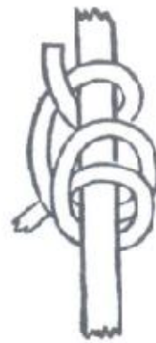
VOLTA DO FIEL DUPLA – é usada em lugar da simples volta de fiel e para amarrar cabos de retenção e espias.
