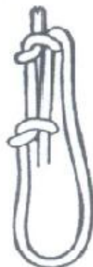
LAÇADA CORREDIÇA – pode ser aumentada ou diminuída conforme seja necessária. Usa-se como esticador para armar toldos ou barracas.
